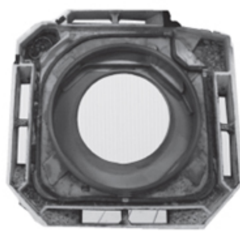
コート剤を施工しなかった場合
